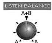
ボリュームを中央に設定すると、A,B チャンネルが均等にミックスされます。この機能を利用して送話していないチャンネルの音を小さい音量でモニターすることができます。
