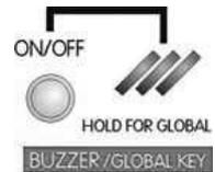
一斉操作モードで、マスターユニットのどちらか一方のチャンネルのコールスイッチを押すと、マスターユニットとすべてのスレーブユニットのコールライトが点滅し、システムに接続されているすべてのユニットにコール信号を送信することができます。
