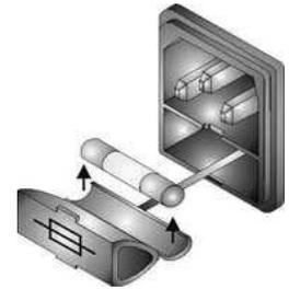
**注意：** ヒューズを交換したときは、交換したヒューズが正しいものであるか確認してください。ふたたびヒューズが切れた場合は、決して容量の大きなヒューズに変えないでください。基板が燃えるなど取り返しの付かないダメージに繋がってしまいます。
