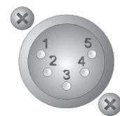
インターカムラインの 1 番ピンは、音声信号の帰線とともに電源の 0 V が接続されています。
