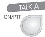
片方のチャンネルのトークスイッチがオフになっているときに、もう片方のチャンネルのトークスイッチをオンにして送話すると、オンにしたチャンネルに接続しているインターカムユーザーと通信することができますが、オフになっているチャンネルに接続しているインターカムユーザーへ送話することはできません。
