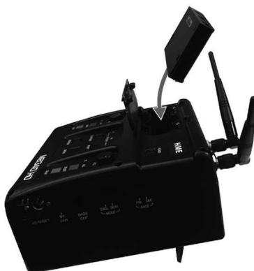
**NOTE:** ベースステーションの電池電圧が低下したときは、ベースステーションのヘッドセットや登録されたベルトバックから、8 秒ごとに警告のための信号音が流れるとともに、**グループ選択表示 LED** が点滅します。
