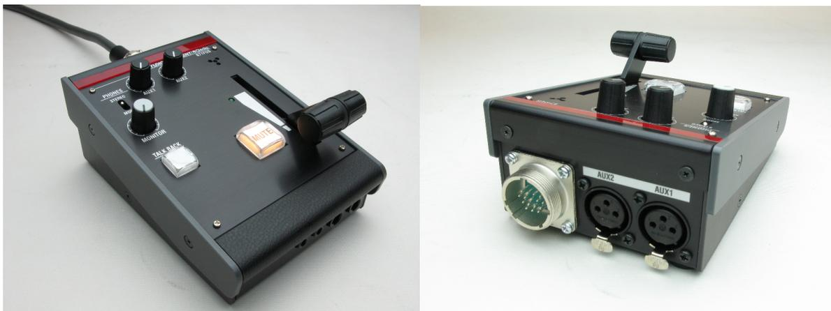
運用上アナウンサーから見えない位置で使用されることの多いテレビ用としても適するよう、見えない位置の操作でも安心感のあるメカニカル押ボタンを採用し、置き場所の自由度を高めるため本体を小型化しました。また、卓上に置いての使用でも、意匠性に十分配慮しています。視認性に優れた CUE ランプも装備し、MA、ラジオなどでの使用にも最適です。
